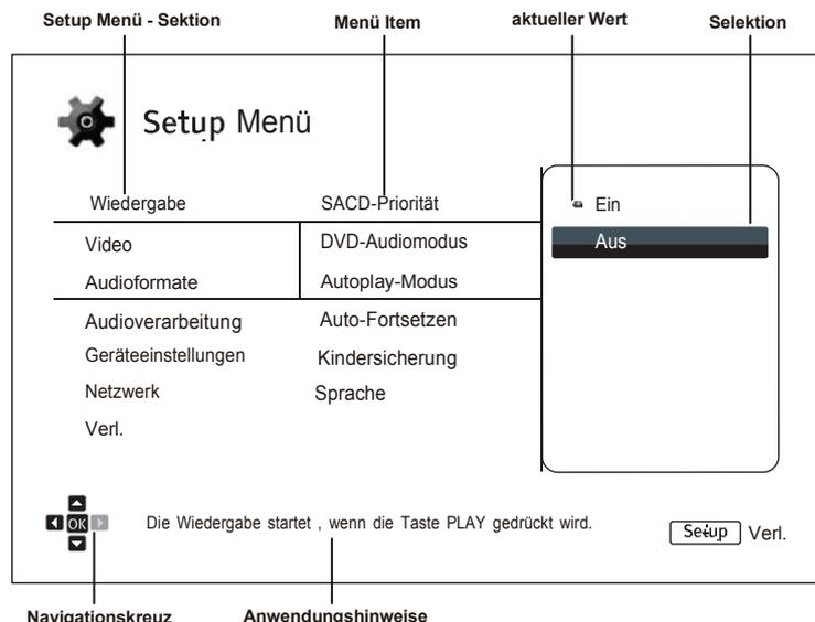
Das Diagramm soll Ihnen einen guten Überblick geben, wie die verschiedenen Teile des **Setup-Menüs** ineinandergreifen. An Hand des Diagramms könnten wir Sie beispielsweise auffordern, den **Auto Play Mode-Parameter** in der Abteilung Playback Setup auf **Aus** zu stellen. Um also im Text mitzuteilen, an welcher Stelle des Menüs wir uns befinden, würden wir folgende Angabe machen: **Wiedergabe-Setup > Auto-Wiedergabe - Modus > Aus**.
