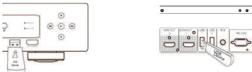
Der OPPO BDP-103EU besitzt drei USB-Anschlüsse (einen an der Front, zwei auf der Rückseite). Sie können den USB-Anschluss dazu nutzen, ein USB-Laufwerk anzustecken.
