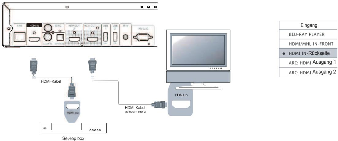
Der BDP-103EU bietet zwei HDMI-Eingänge, einen auf der Vorderseite und einen auf der Rückseite. Sie können über das mitgelieferte HDMI-Kabel ein Quellgerät, wie beispielsweise eine digitale TV-Box, ein Handy oder einen Camcorder an den HDMI IN-Eingang anschließen. Benutzen Sie die Taste "INPUT" auf der OPPO Fernbedienung, um im Menü "Eingangsquelle" den entsprechenden HDMI-IN-Eingang auswählen zu können.
