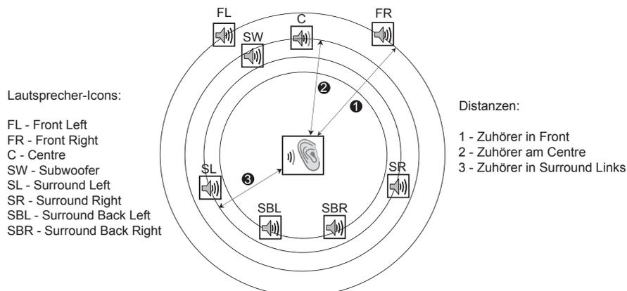
In der obigen Abbildung messen Sie den Abstand (in Meter) von der primären Hörposition zum rechten und linken Frontlautsprecher. Geben Sie den Abstand der Frontlautsprecher ( ❶ im Bild oben) in das **Lautsprecher-Konfigurationsmenü**.
